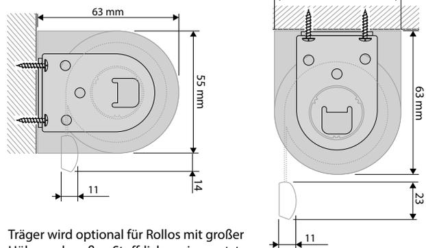
Träger wird optional für Rollos mit großer Höhe und großen Stoffdicken eingesetzt.
